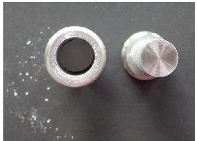
3 Stempel der Prüfapparatur mit geschlossener Bodenplatte • Plunger of the test apparatus with closed base plate
