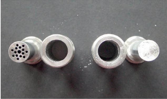
4 Stempel der Prüfapparatur mit geschlossener und perforierter Bodenplatte • Plunger of the test apparatus with closed and perforated base plate
