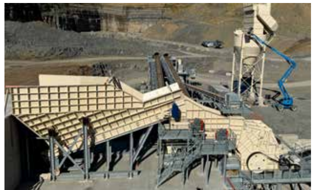
Vorbrechanlage mit integriertem Fingerrollenrost Primary crushing plant with integrated finger roller screen
